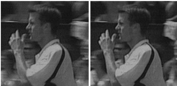
**Abbildung 11** Links: Mobil empfangenes Bild mit Zeilensprungartefakte. Rechts: Bild nach der Signalnachverarbeitung.
