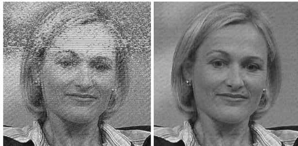
**Abbildung 6** Links: Mobil empfangenes Bild mit Zeilenimpulsrauschen. Rechts: Bild nach der Signalnachverarbeitung.
